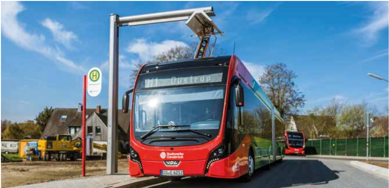
Abbildung 137: Opportunity-Charging-Vorgang an der Endhaltestelle Haste der MetroBus-Linie M1
