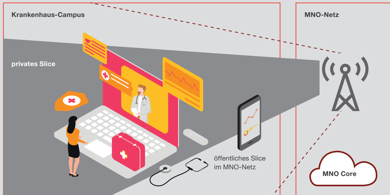
Abbildung 2: Virtuelles 5G-Campusnetz als Slice im MNO-Netz
